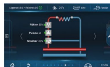
Monitoring/obsługa ręczna obiegu grzewczego
