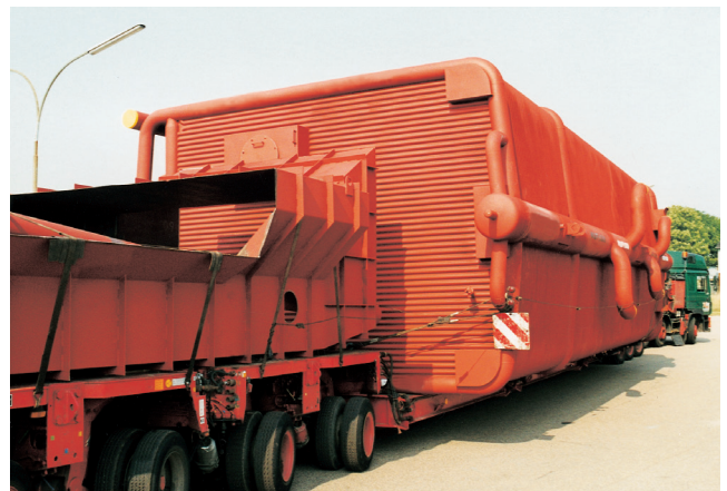
Zdjęcie 2: Ciepła woda 100 MW - kocioł wodnorurkowy podczas transportu
