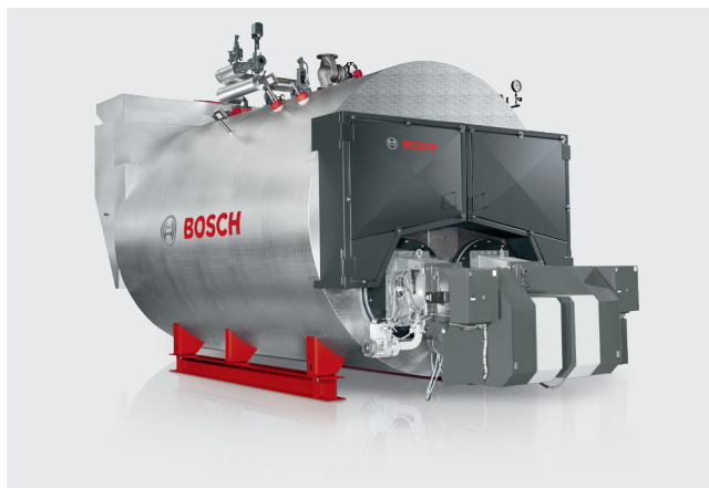
Zdjęcie 1: Wysokociśnieniowy kocioł płomienicowo-płomieniówkowy, konstrukcja dwupaleniskowa, 35 t/h, 16 bar
