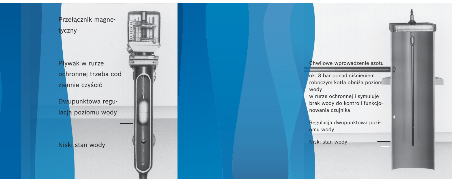
Rysunek 1: Pływakowy ogranicznik poziomu wody - konieczne kontrole wyłączenia awaryjnego i codzienne przedmuchiwanie.
